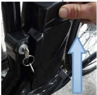
Der montierte Akku ist auf der Abbildung zu sehen.
